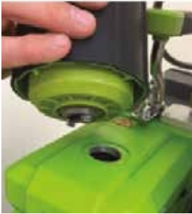
JOONIS 7: uudeemaldaja eemaldatud, näitab õliava
