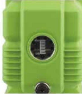
JOONIS 8: Vaateklaas, mis näitab õlitaset
